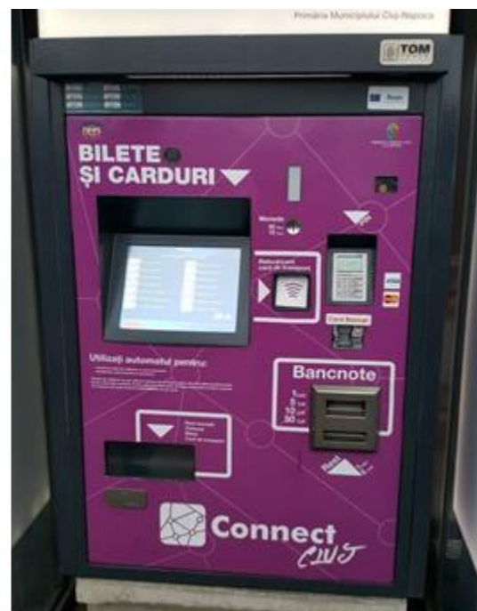
Figura 8. CTP Cluj – Panou de afișaj pentru informații (sistem Wink) și automat de taxare electronică (sistem CS Vision)
